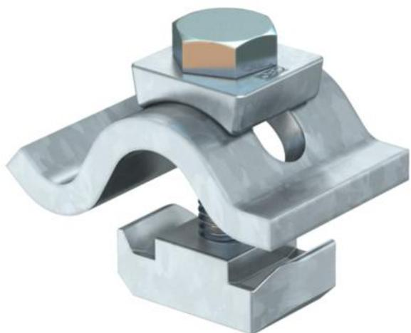
Spannklaue mit Gleitmutter für die Befestigung von Profilschienen an Stahlträgern. Der Spannungsbereich der Spannklaue ist auf die max. Befestigungsdicke 25 mm begrenzt.
